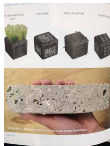
写真3 生きたブレイクウォーターの基盤となる素材とユニット
