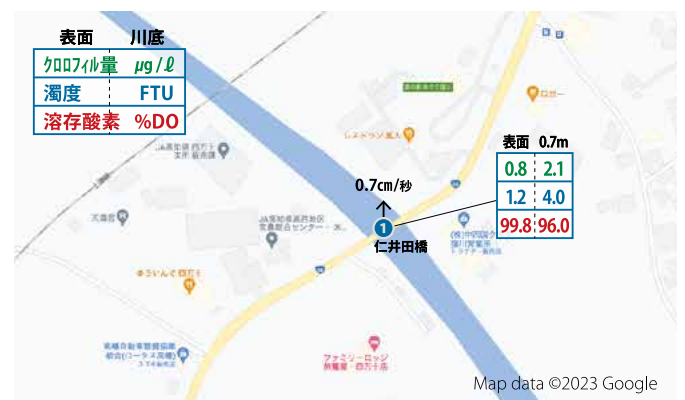
図3 仁井田川橋 クロロフィル量、濁度と溶存酸素及び流向・流速 2024年1月17日
