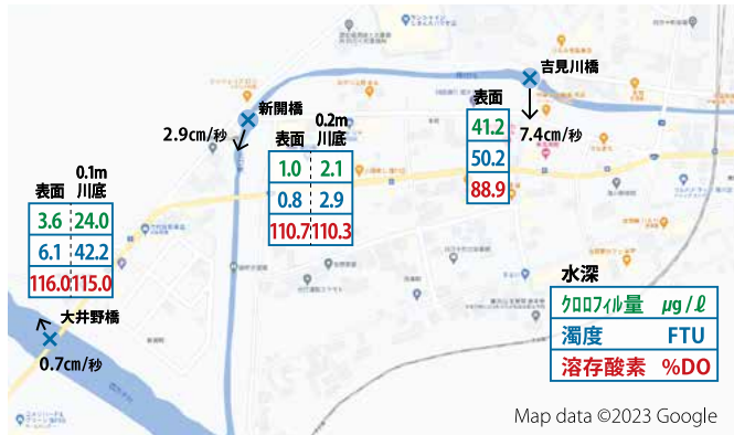
図4 吉見川橋、新開橋と大井野橋のクロロフィル量、濁度と溶存酸素及び流向・流速 2024年1月15日
