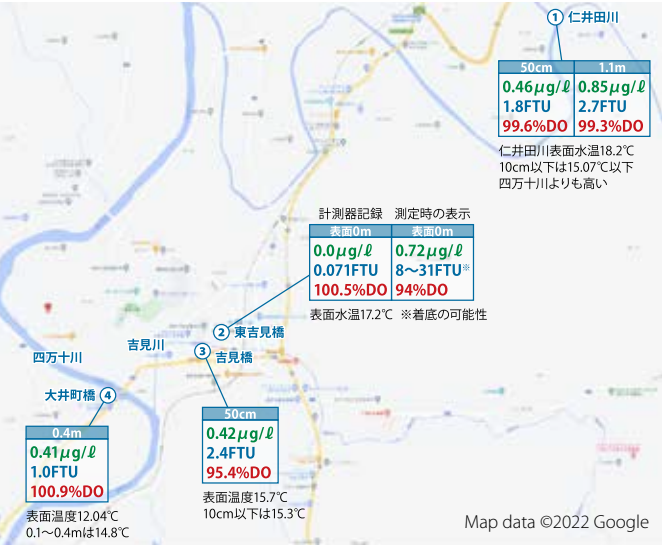
図2：四万十川中流域；窪川地区での計測地点とクロロフィル量、濁度（FTU）と溶存酸素量（DO）計測結果
