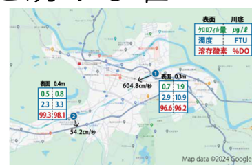
図3 奈良川のクロロフィル量、濁度と溶存酸素、及び流向・流速 2024年5月13日
